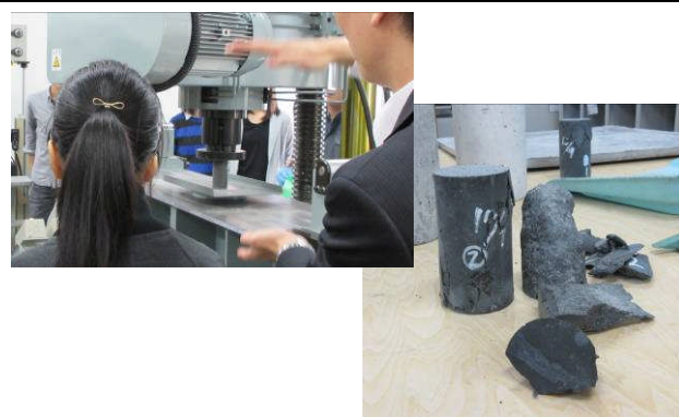
（左写真）研究室訪問《ライフサイクル工学研究室》にて、コンクリート建材の強度の比較。 （右写真）コンクリート柱の破壊実験後、左は破壊後でも形を保持、右は粉々。
